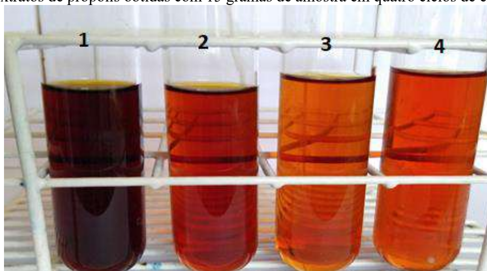
Figura 1 - Extratos de própolis obtidas com 15 gramas de amostra em quatro ciclos de extração
